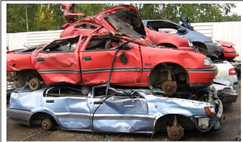
Autoista irrotetaan ensin pyörät ja poistetaan nesteet ja akut
